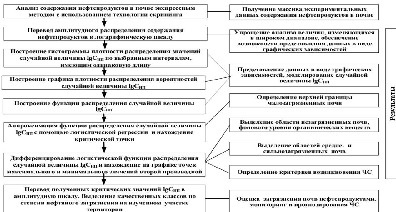
Рисунок 14 – Последовательность реализации метода оценки уровня нефтяного загрязнения почв при мониторинге и прогнозировании ЧС, возникающих на территории объектов НГДП
