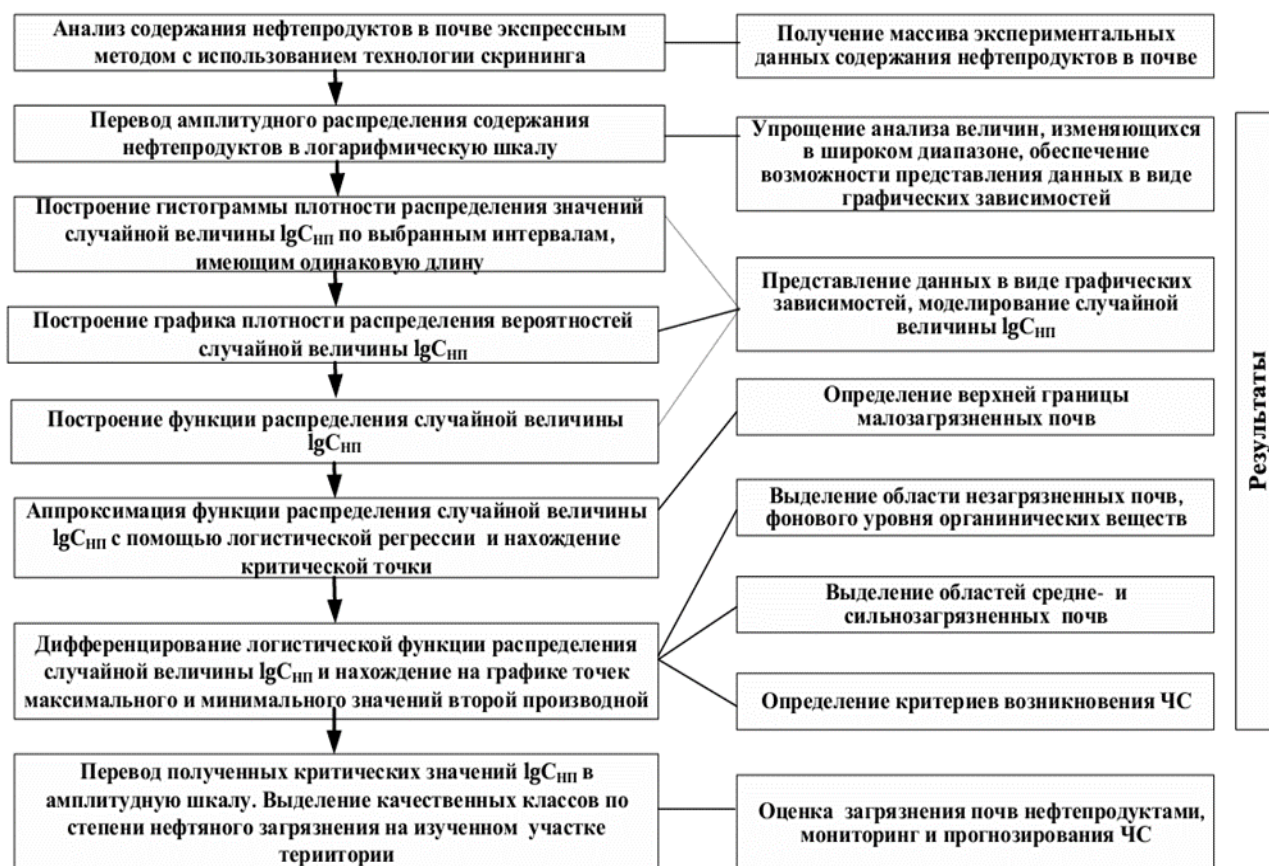
Рисунок 4.14 – Последовательность реализации метода оценки уровня нефтяного загрязнения почв при мониторинге и прогнозировании ЧС, возникающих на территории объектов НГДП
