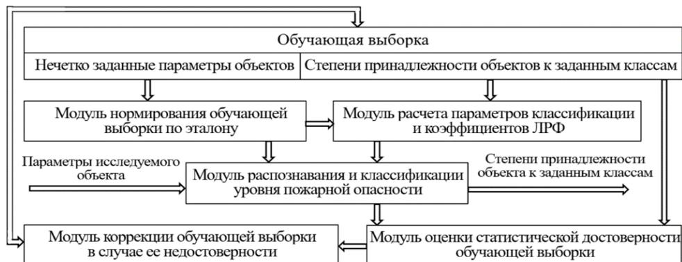
Рисунок 2 – Структурная схема многомерного классификатора
