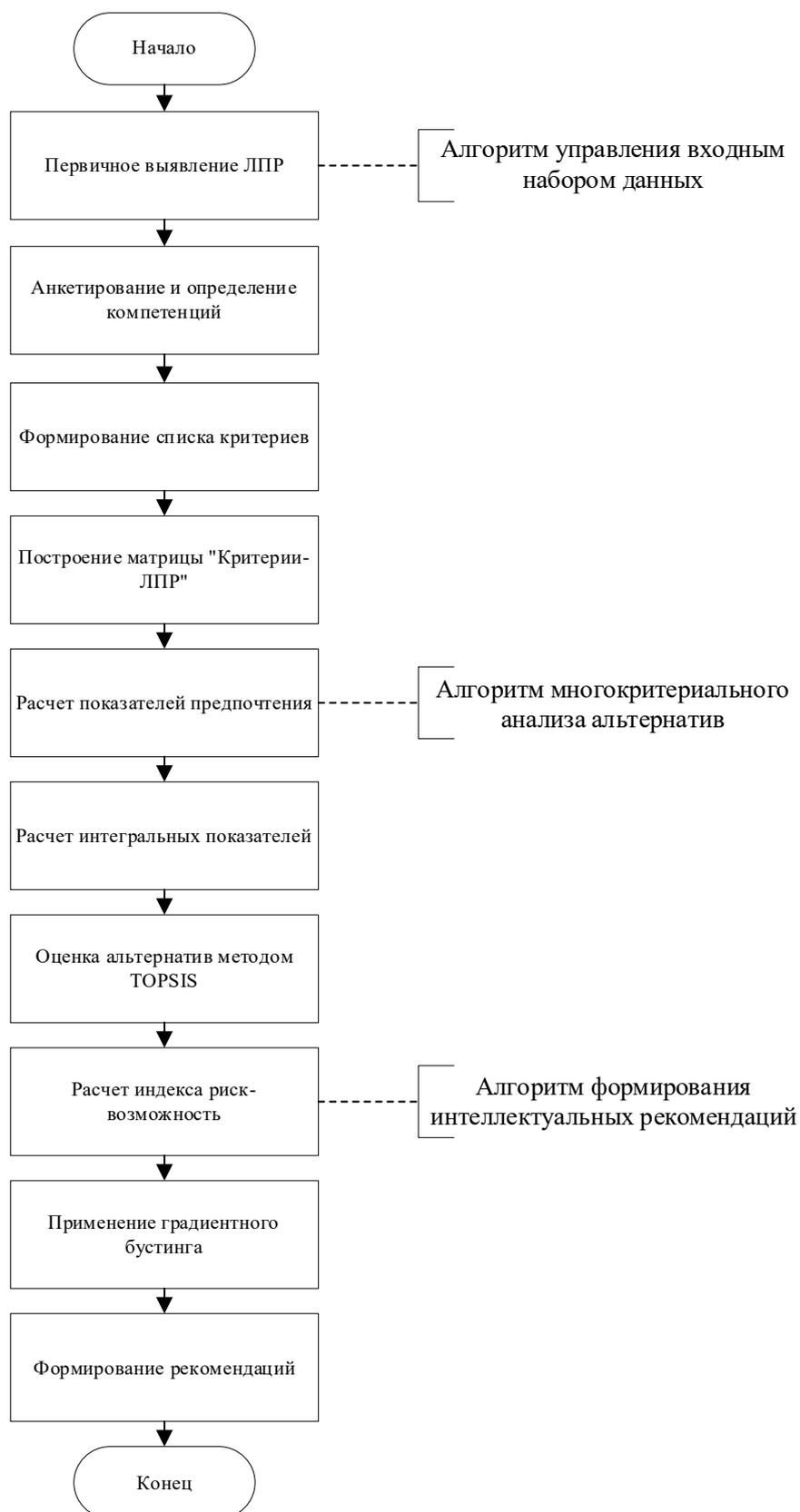
Рисунок 5 – Схема комплексного алгоритма интеллектуальной поддержки принятия решений
