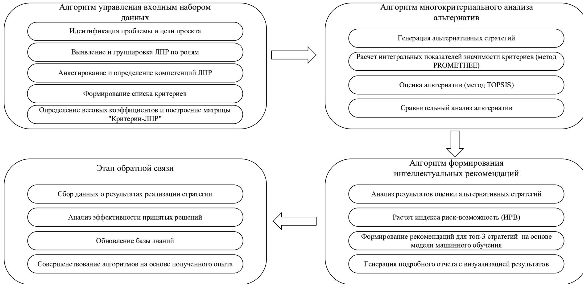
Рисунок 8 – Структурная схема комплексного алгоритма интеллектуальной поддержки принятия решений
