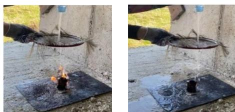
Рисунок 9 – Моделирование работы системы водяного пожаротушения при подаче воды сквозь базальтовую сетку
