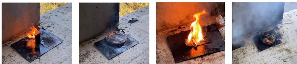
Рисунок 8 – Локализация пожара базальтовой сеткой
