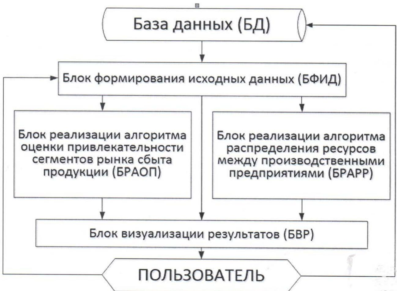
Рисунок 4.2 – Блок-схема комплекса проблемно-ориентированных программ, обеспечивающих поддержку принятия решений при управлении производственной деятельностью предприятий УИС
