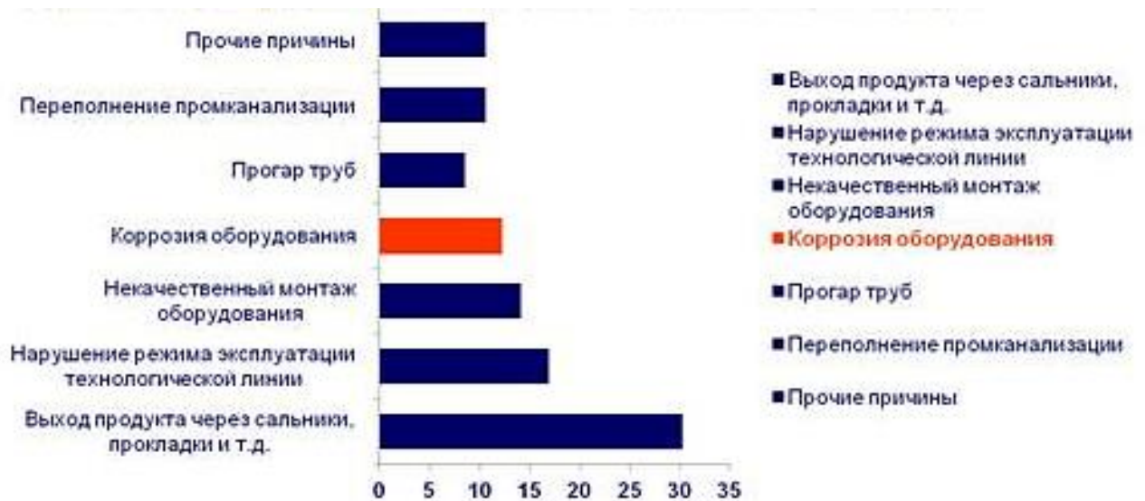
Рисунок 1.9 – Распределение причин аварий на технологических установках на объектах нефтегазового комплекса
