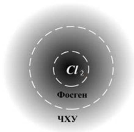
Рисунок 4.7 – Пространственное распределение областей токсического заражения для локального горения в газовой фазе при недостатке воды
