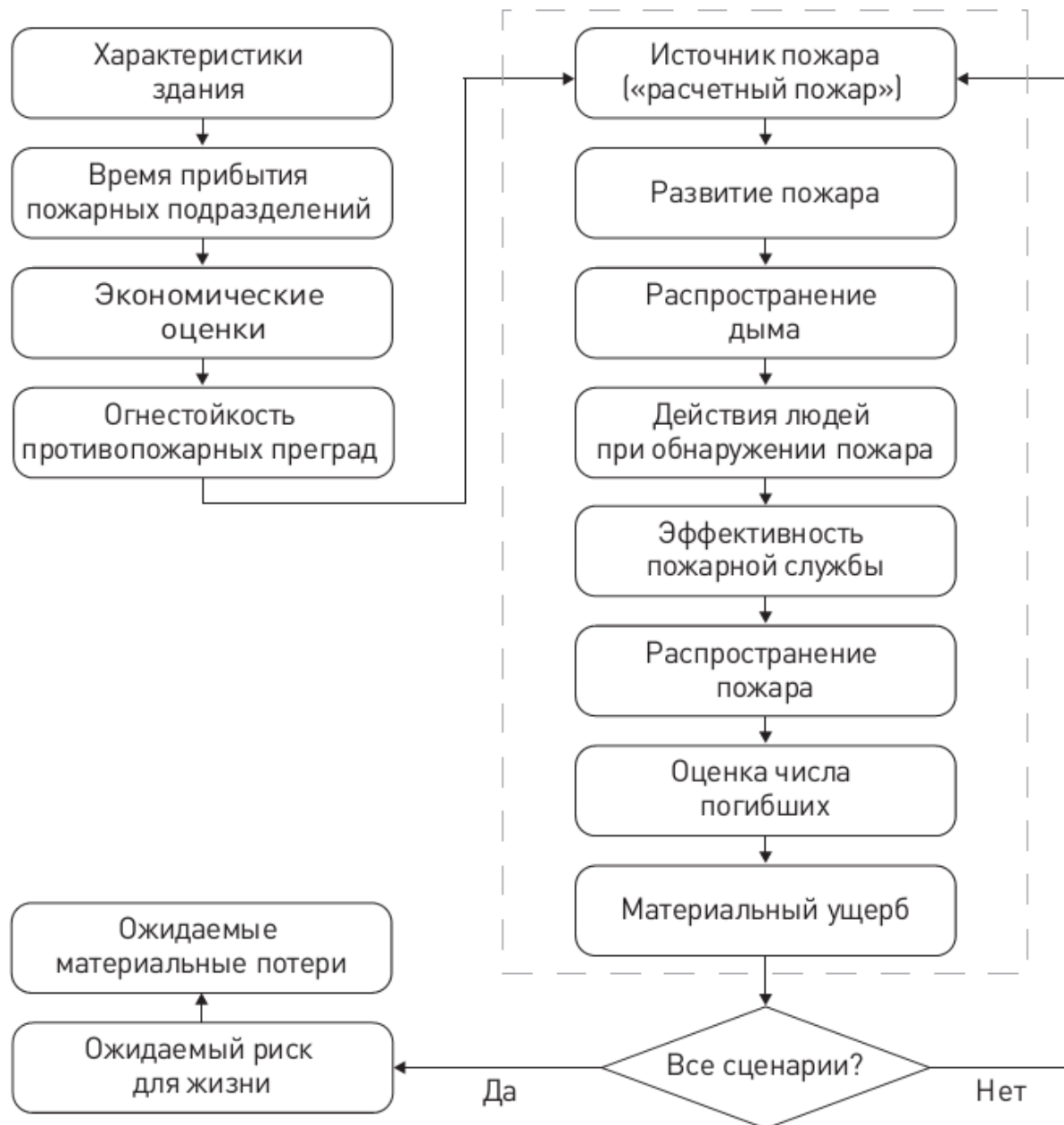
Рисунок 1.11 – Структура взаимосвязей моделей алгоритма программы FiRECAM
