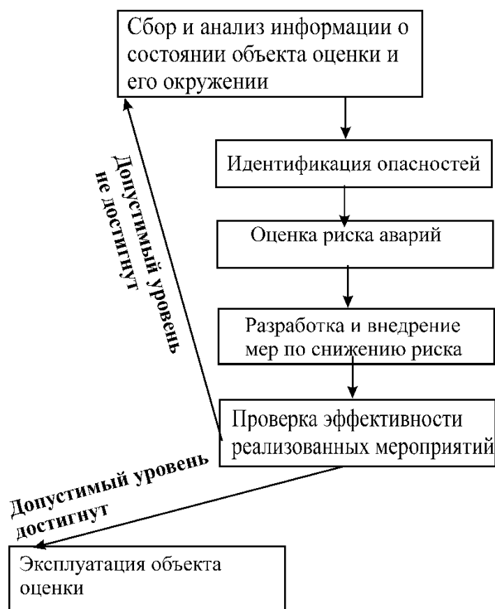
Рисунок 4.1 – Схема процедуры анализа пожарного риска
