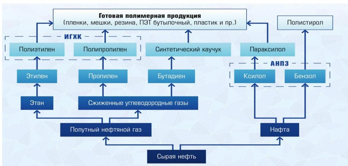
Рисунок 4 – Структурная схема переработки нефти и нефтепродуктов
