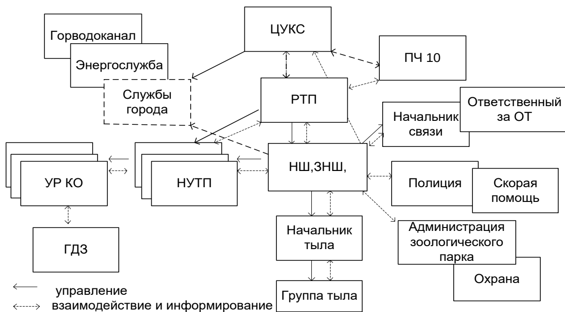
Рисунок 2.2 – Структура управления тушением пожара с учетом иерархии должностных лиц различных оперативных подразделений
