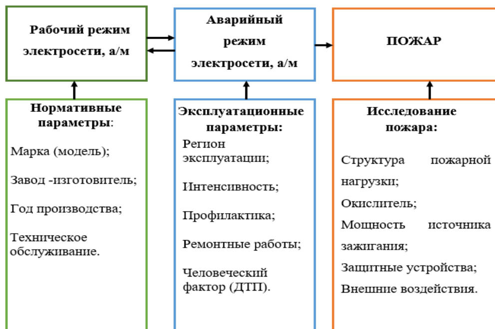
Рисунок 15 – Параметры, влияющие на состояние автотранспортного средства на каждом этапе эксплуатации (параметры, вносимые в программный комплекс)
