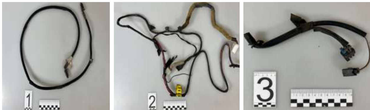
Рисунок 7 - Фрагменты коммутационных элементов автомобиля
