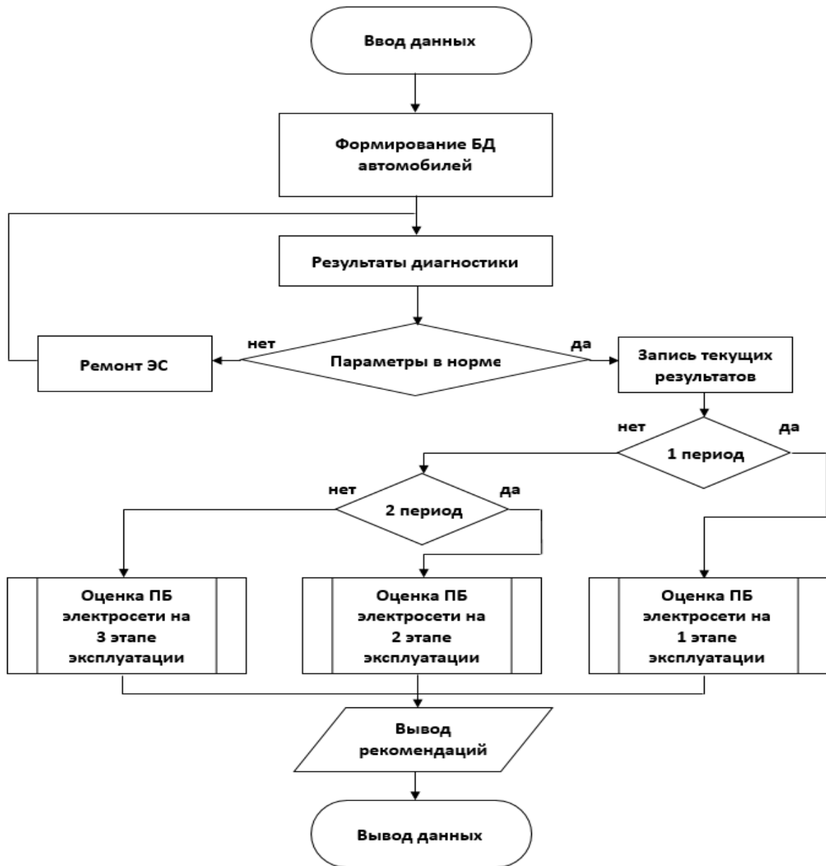
Рисунок 17 – Алгоритм оценки пожарной безопасности электросети автотранспортного средства.
