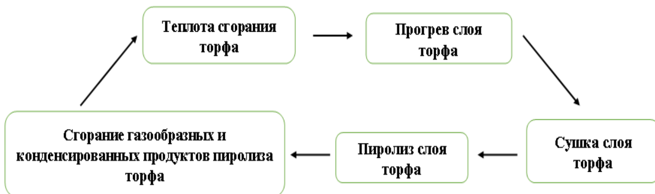
Рисунок 2.3 – Схема основных физико-химических процессов во фронте торфяного пожара
