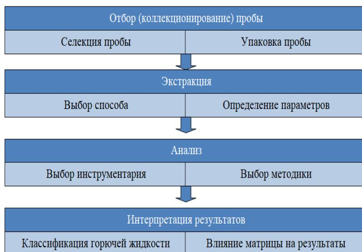
Рисунок 17 – Аналитический процесс исследования горючих жидкостей Джэя
