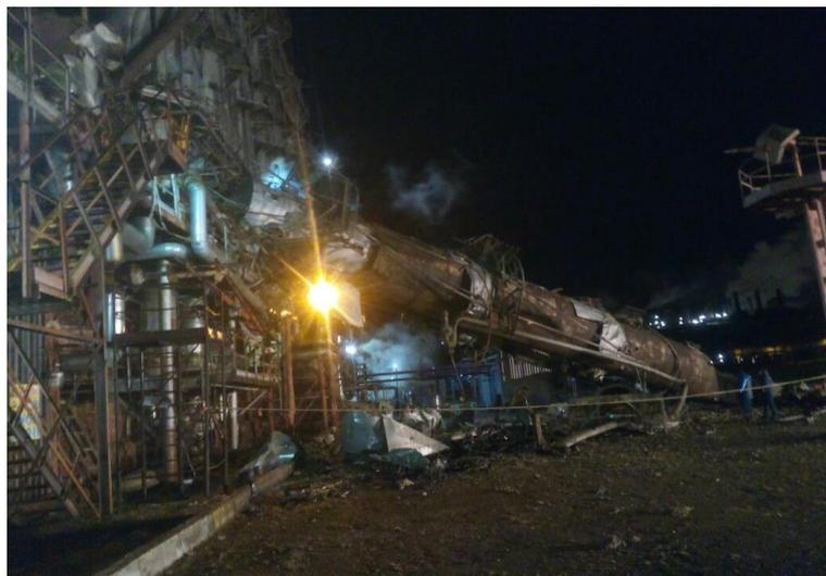
Рисунок 6 – Последствия взрыва при проведении испытания колонны на герметичность
