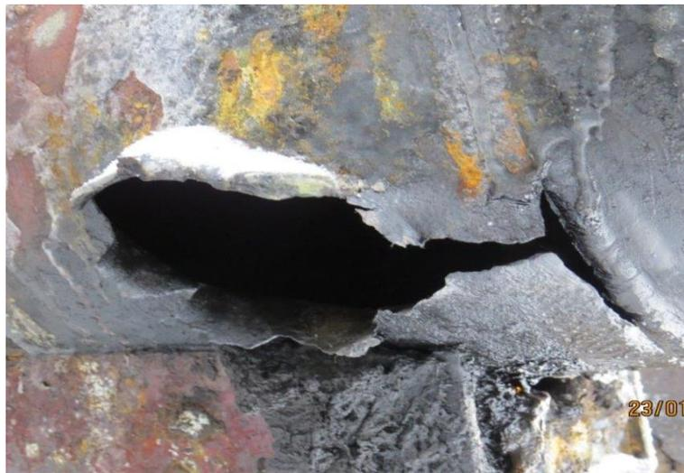
Рисунок 3 – Разрушение участка трубопровода вследствие утонения, с последующим возгоранием
