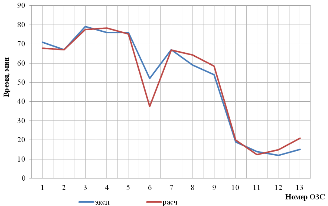
Рисунок 3.9 – Результаты экспериментальных ( \tau_{\text{эксп}} ) и расчетных ( \tau_{\text{расч}} ) данных огнезащитной эффективности
