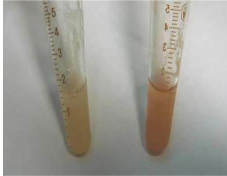
Рисунок 24 – Сравнение окрашивания осадков ламп BDE-90C (слева) и ЛД-80 (справа)
