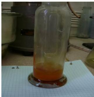
Рисунок 4.13 – Внешний вид склянки Дрекслея, с полученным продуктом (температура минус  $20,5^{\circ}\text{C}$ )
