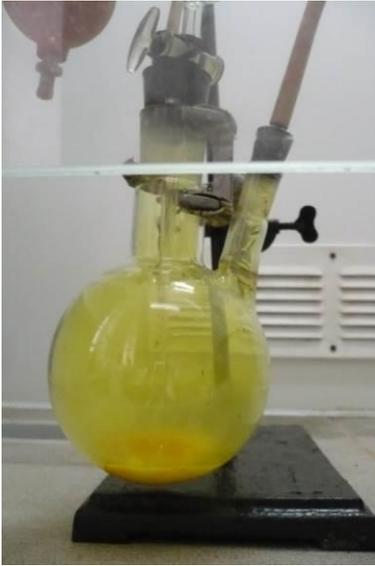
Рисунок 4.46 – Выделение  $\text{ClO}_2$ , окрашивание  $\text{KClO}_3$  в оранжевый цвет
