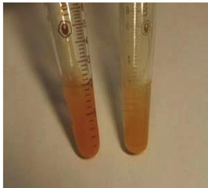
Рисунок 5.25 – Сравнение окрашивания осадков ламп BDE-90C (справа) и ЛД-80 (слева)
