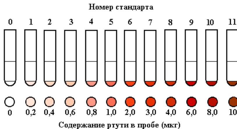
Рисунок 5.9 – Стандартная колориметрическая шкала.
