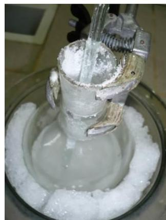
Рисунок 4.52 – Общий вид колбы с  $P_2O_5$ , взаимодействующей с водным раствором хлорной кислоты
