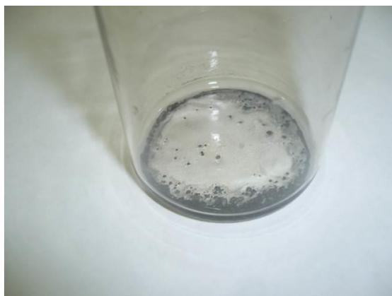
Рисунок 4.50 – Результат взаимодействия водного раствора оксида хлора (IV) и капли ртути
