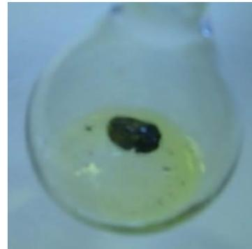
Рисунок 4.33 – Время взаимодействия при встряхивании капли ртути в растворе 7 с
