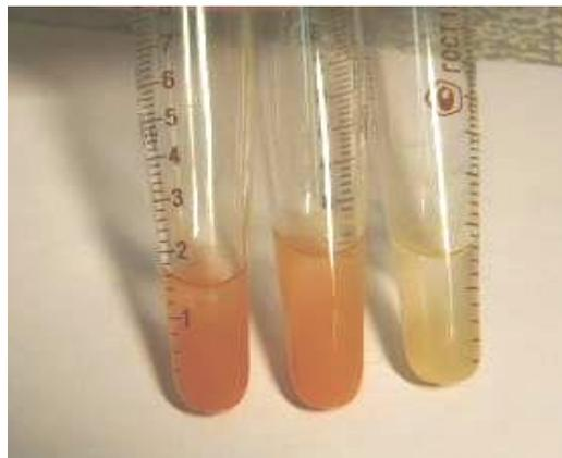
Рисунок 5.33 – Сравнение трех растворов по выявлению ртути из люминофора лампы ЛД-80 после 1(слева), 2 (по центру), и 4 (справа) определений
