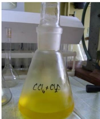
Рисунок 4.7 – Внешний вид оксида хлора (I), растворенного в четыреххлористом углероде в конической колбе с притертой крышкой
