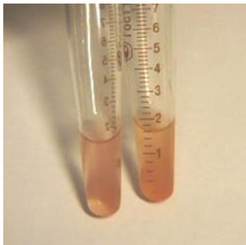
Рисунок 5.35 – Сравнение осадков темного (слева) и светлого (справа) люминофоров для лампы Philips PL-S 2P
