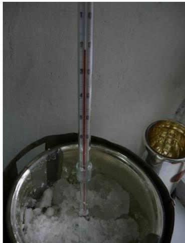
Рисунок 4.11 – Внешний вид сосуда Дьюара, заполненного льдом и солью с температурой минус 20°C. Время удержания данной температуры в комнатных условиях составило 3 часа
