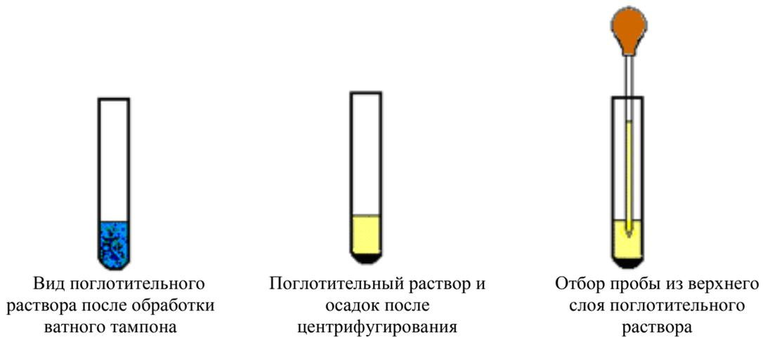
Рисунок 5.15 – Этапы обработки и отбора загрязненной пробы
