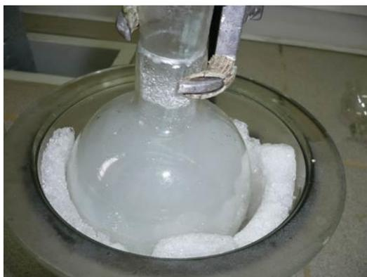
Рисунок 4.53 – Образование окиси хлора (VII) в виде белого пара, растворяющегося в  $CCl_4$
