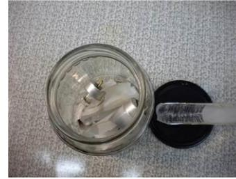
Рисунок 5.19 – Разбитая лампа и кусок стекла, с которого снят люминофор
