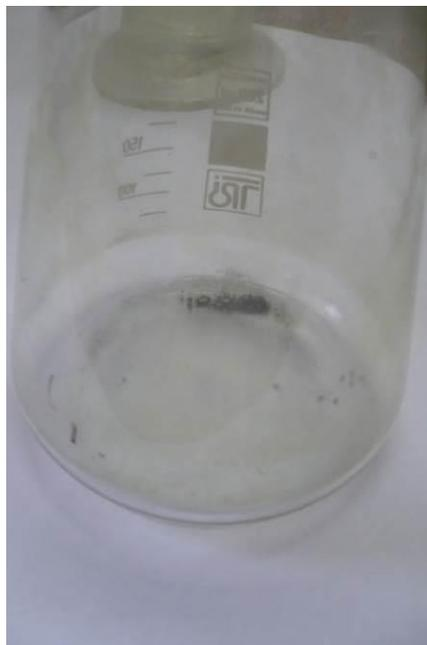
Рисунок 4.49 – Результат взаимодействия капли ртути с раствором  $\text{ClO}_2$  в  $\text{CCl}_4$
