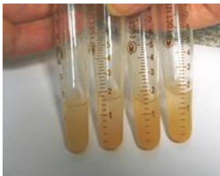
Рисунок 5.31 – Результаты 4-х определений ртути в люминофоре лампы BDE-90C
