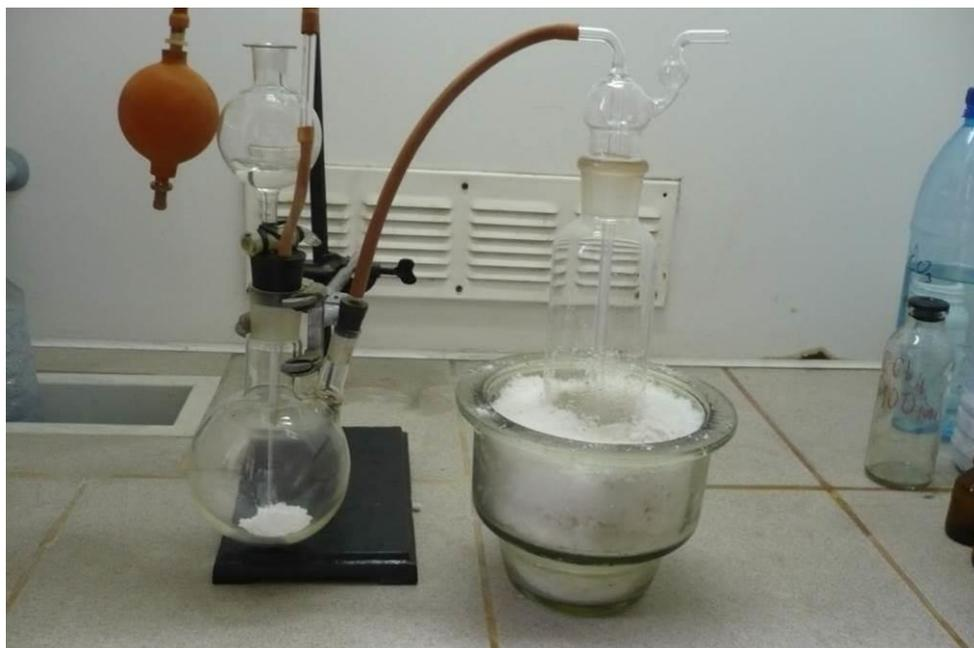
Рисунок 4.44 – Внешний вид лабораторной установки для синтеза оксида хлора (IV) –  $\text{ClO}_2$
