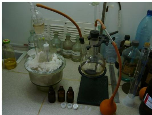
Рисунок 4.8 – Установка получения окиси хлора с контролем температуры
