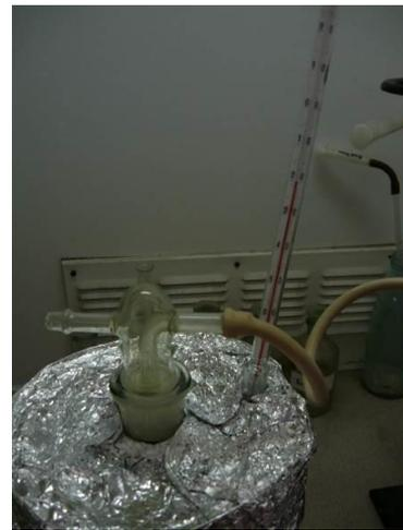
Рисунок 4.12 – Внешний вид склянки Дрекслея, размещенной в сосуде Дьюара (температура минус 20,5°C)
