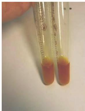
Рисунок 5.22 – Пробирки с люминофором от ламп BDE-90C и ЛД-80 и поглотительным раствором
