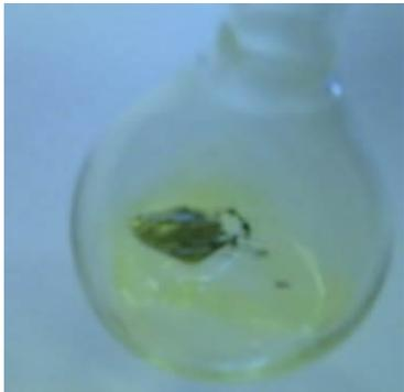
Рисунок 4.32 – Время взаимодействия при встряхивании капли ртути в растворе 5 с
