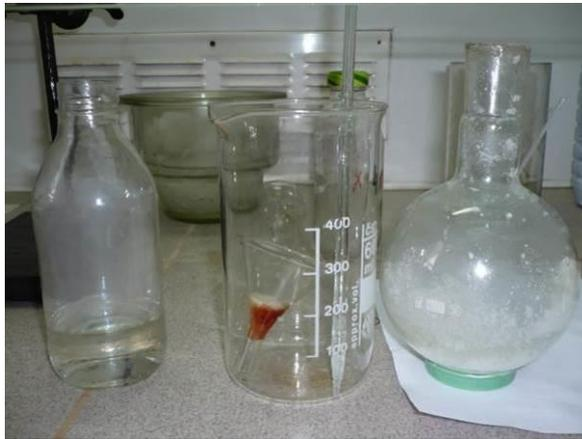
Рисунок 4.55 – Раствор окиси хлора (VII) в тетрахлориде углерода, побуревшая стекловата в воронке, остатки пятиокси фосфора после проведения синтеза
