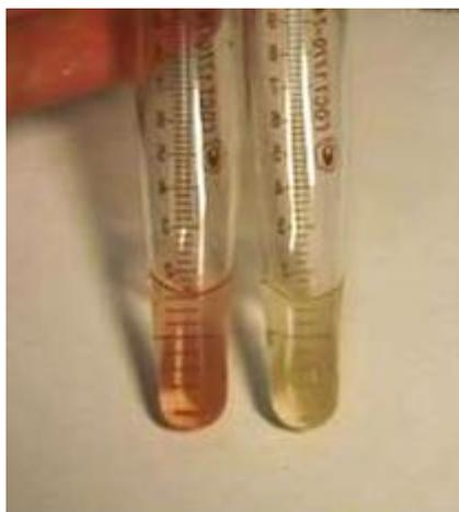
Рисунок 5.36 – Сравнение осадков темного (слева) и светлого (справа) люминофоров для лампы Philips PL-S 2P при повторной анализе
