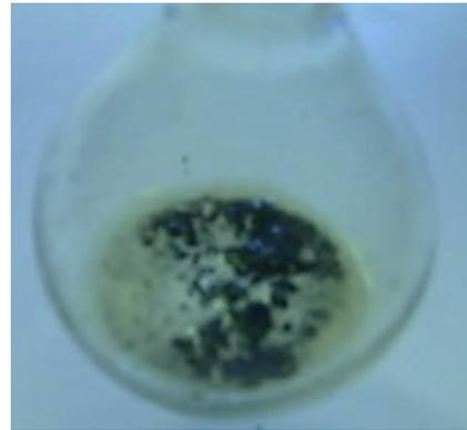
Рисунок 4.37 – Время взаимодействия при встряхивании капли ртути в растворе 30 с
