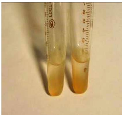
Рисунок 5.27 – Сравнение окрашивания осадков ламп ВДЕ-90С (справа) и ЛД-80 (слева)
