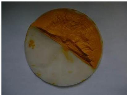
Рисунок 4.15 – Вид окиси ртути, полученной при взаимодействии нитрата ртути и щёлочи NaOH
