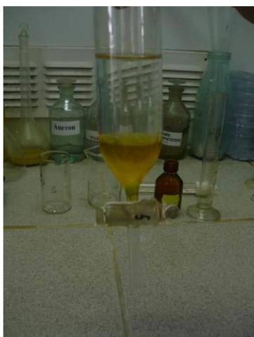
Рисунок 4.41 – Общий вид делительной воронки с раствором окиси хлора в тетрахлориде углерода (нижний слой) и водой
