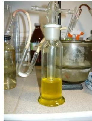
Рисунок 4.60 – Общий вид раствора хлора без примеси хлористого водорода в тетрахлориде углерода
