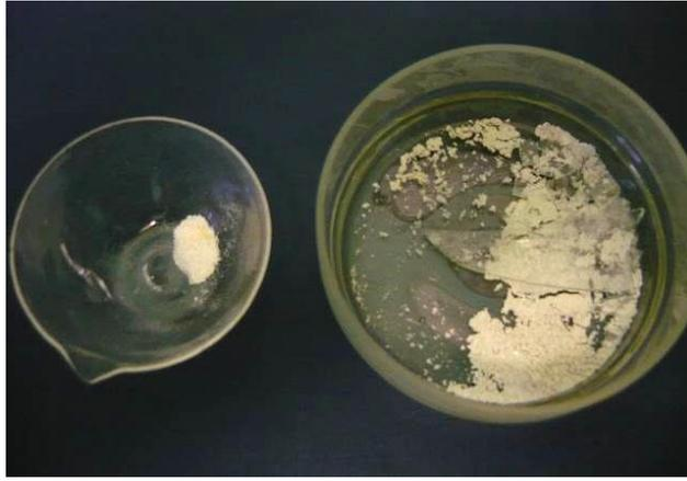
Рисунок 5.21 – Люминофор лампы BDE-90C (слева) и ЛД-80 (справа)
