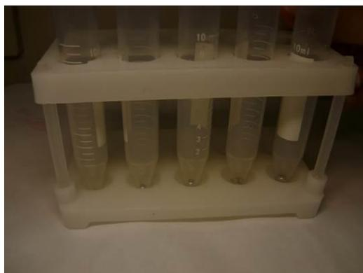
Рисунок 4.1 – Ртуть внесенная капилляром в пробирки перед добавлением 10 мл хлористого метилена.
