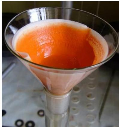
Рисунок 4.4 – Внешний вид отфильтрованного оксида ртути (II)
