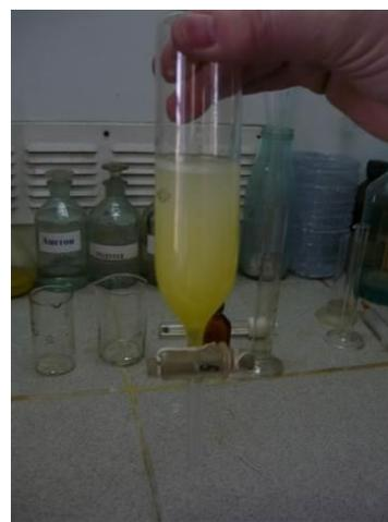
Рисунок 4.42 – Общий вид перемешивания растворов с целью увеличения коэффициента перехода окиси хлора в водную фазу
