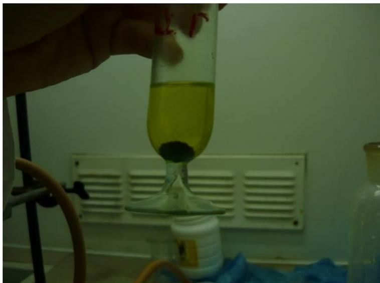
Рисунок 4.58 – Результат взаимодействия капли ртути с раствором  $\text{Cl}_2$  в  $\text{CCl}_4$
