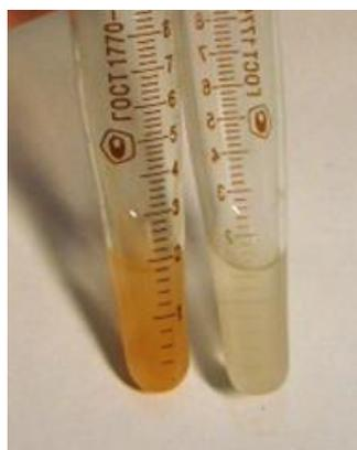
Рисунок 5.37 – Сравнение осадков темного (слева) и светлого (справа) люминофоров для лампы Philips PL-S 2P при третьем определении
