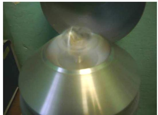
Рисунок 5.23 – Центрифугирование при скорости 5000 об/мин в течение 1–1,5 минуты
