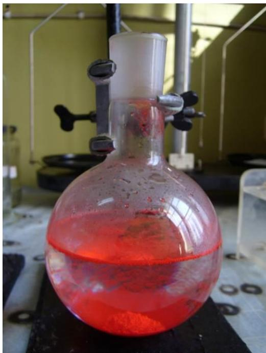
Рисунок 4.2 – Общий вид иодида ртути (II) до реакции
