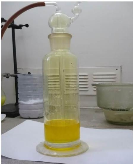
Рисунок 4.48 – Склянка Дрекслея с раствором  $\text{ClO}_2$  в  $\text{CCl}_4$
