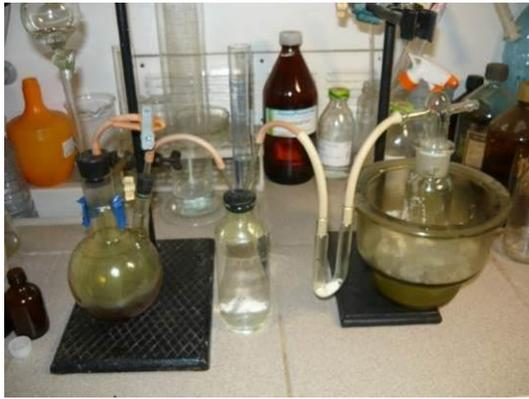
Рисунок 4.59 – Установка получения хлора без примеси хлористого водорода
