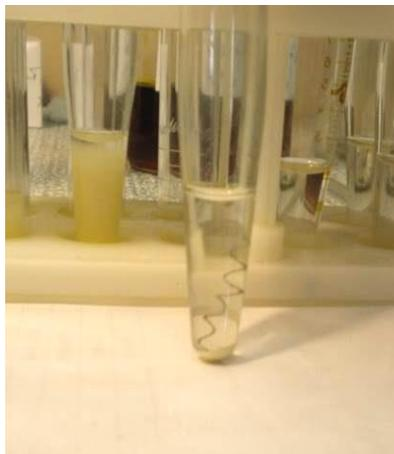
Рисунок 5.39 – Обнаружение ртути в пробирке с вольфрамовой пружиной
