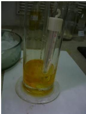
Рисунок 4.18 – Внешний вид продукта при израсходовании 30 мл соляной кислоты
