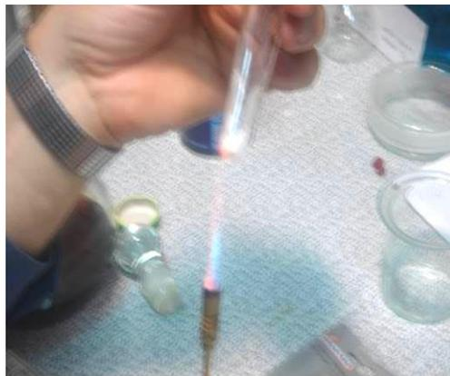
Рисунок 5.38 – Нагрев люминофора до температуры 600–700°C
