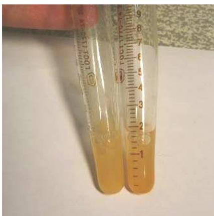
Рисунок 5.32. – Результаты 1 (слева) и 5 (справа) определения ртути в люминофоре лампы BDE-90C
