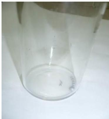
Рисунок 4.56 - Общий вид капли ртути после приливания раствора  $Cl_2O_7$  в  $CCl_4$
