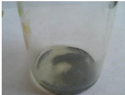
Рисунок 4.38 – Общий вид окисленной ртути спустя 4–5 минут последобавления раствора  $\text{Cl}_2\text{O}$  в  $\text{CCl}_4$
