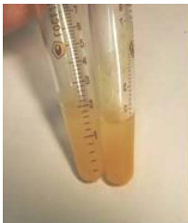
Рисунок 5.26 – Сравнение окрашивания осадков ламп ВДЕ-90С (справа) и ЛД-80 (слева)
