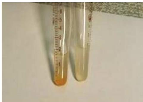
Рисунок 5.29 – Сравнение окрашивания осадков ламп BDE-90С (слева) и ЛД-80 (справа)
