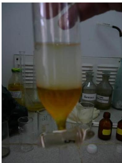
Рисунок 4.43 – Третья рекстракция окиси хлора из тетрахлорида углерода в воду.
