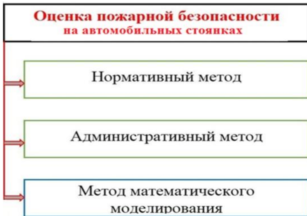
Рисунок 4 - Методы повышения пожарной безопасности автостоянок
