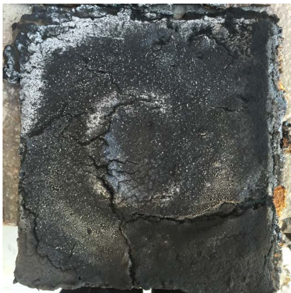
Рисунок 27 – Вспучивание огнезащитного покрытия Chartek-1709 после 10 мин проведения испытания при температуре 1100 °С
