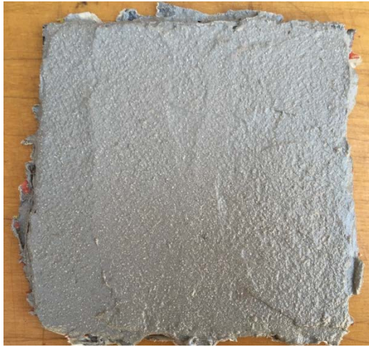
Рисунок 23 – Огнезащитный состав Chartek-1709, нанесенный на металлическую пластину
