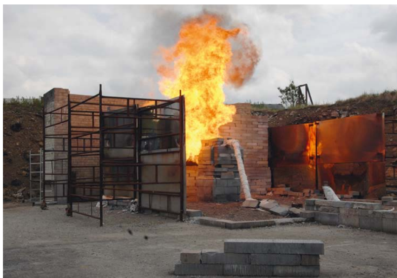
Рисунок 13 – Проведение испытаний по международному стандарту ISO 22899-1:2007 и ISO/CD 22899-2:2009
