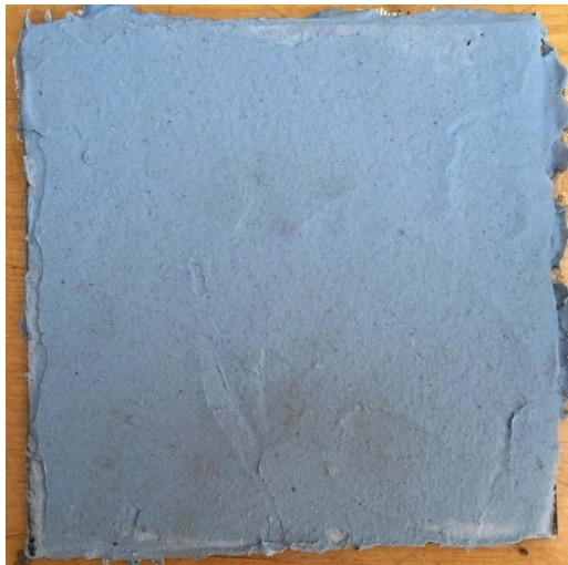
Рисунок 24 – Огнезащитный состав ПЗСМ, нанесенный на металлическую пластину
