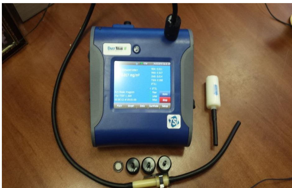
Рисунок 3 – Прибор DUSTTRAK 8530 , с пробоотборником и 4-мя сменными фильтрами для отсеивания частиц PM_{10} , PM_4 , PM_{2.5} и PM_1
