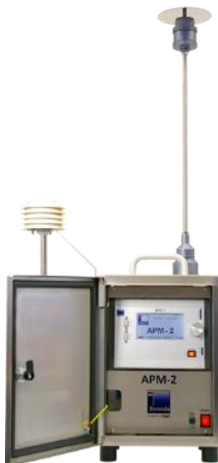
Рисунок 5 – Прибор АРМ-2 для автоматического пробоотбора и непрерывного измерения PM_{10} и PM_{2.5} в атмосферном воздухе
