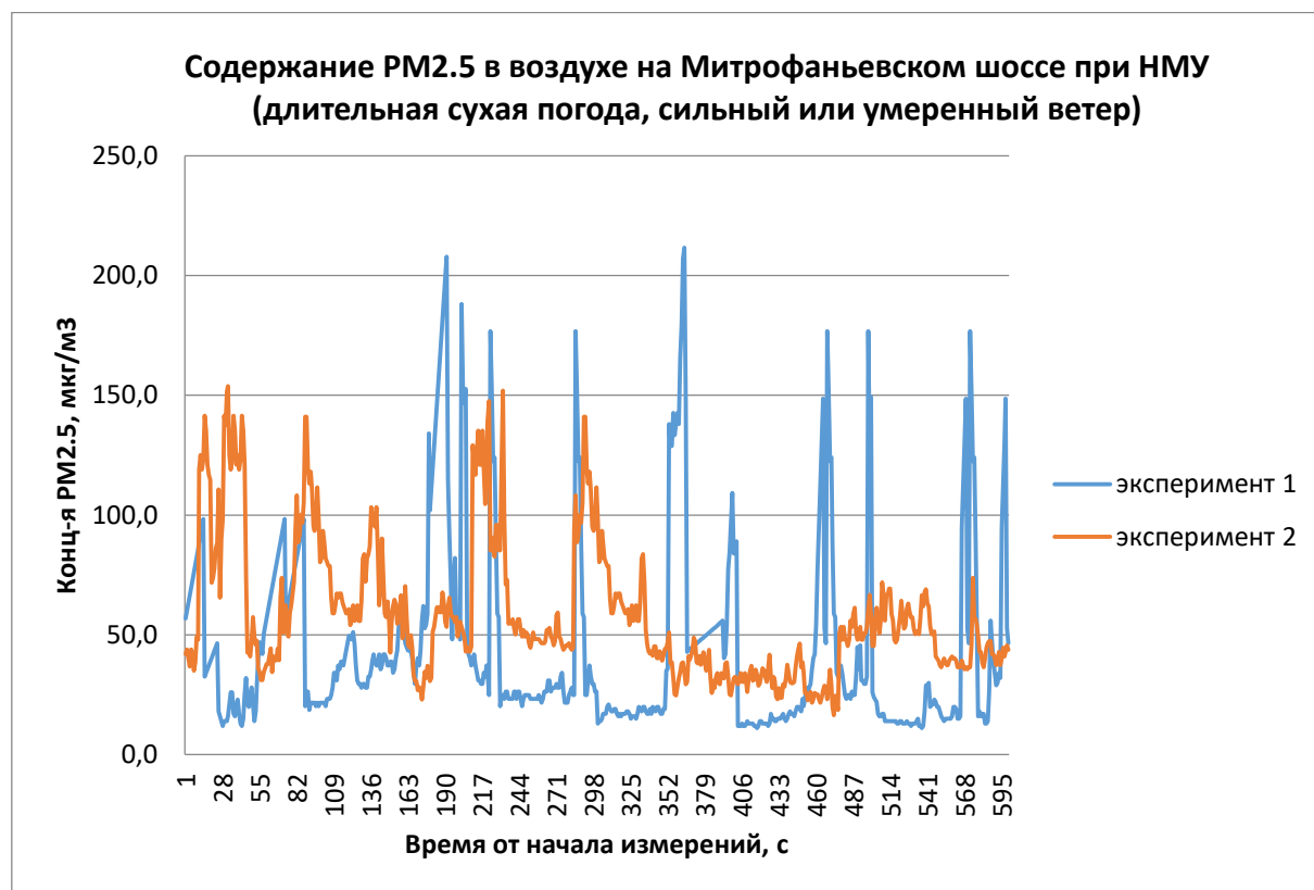
Рисунок 11(г) Диаграммы on-line измерений концентраций PM 2.5 на Митрофаньевском шоссе при НМУ
