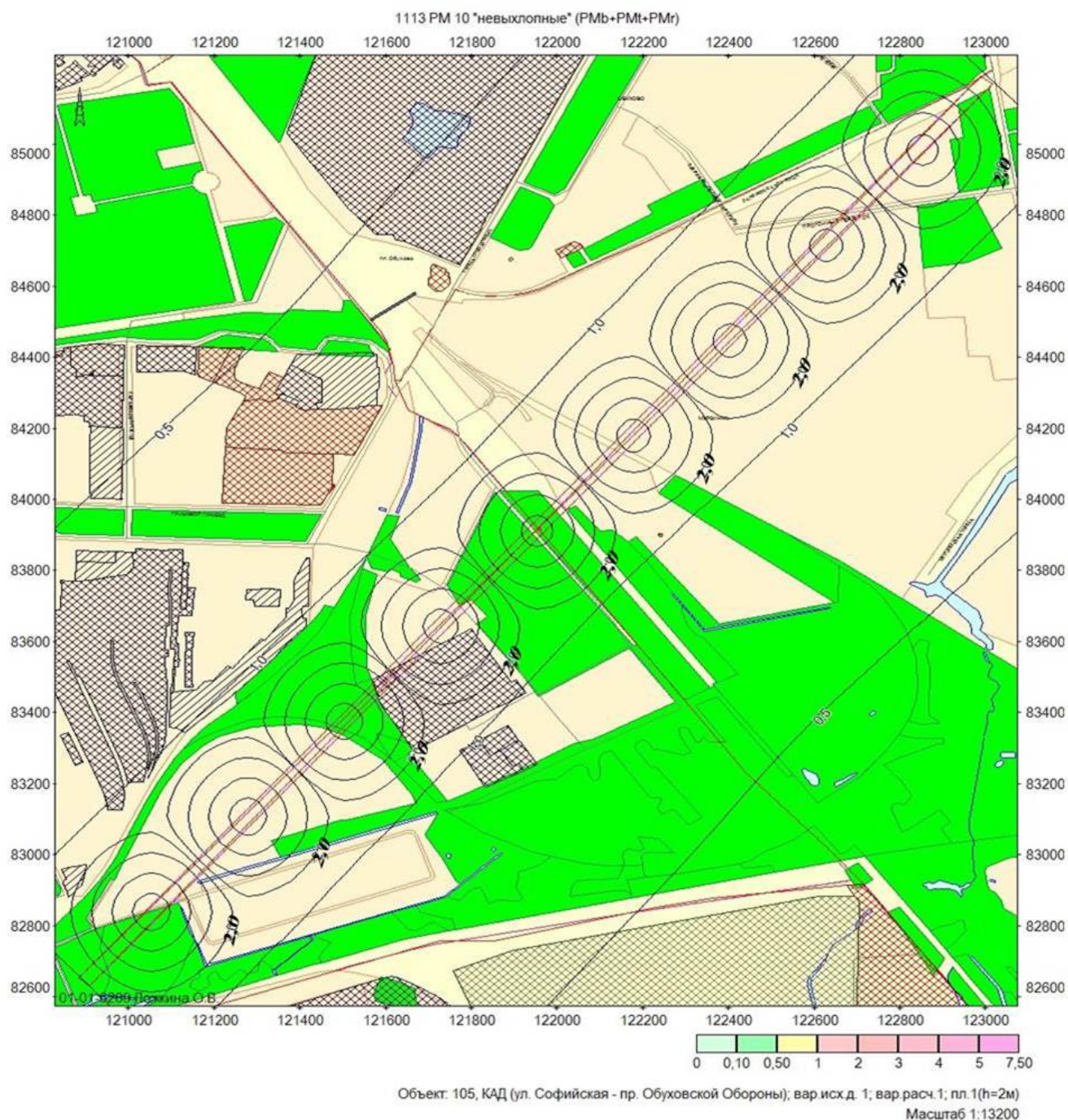
Рисунок 25 (в) – Визуализация загрязнения приземного воздушного бассейна «невыхлопными» частицами PM 10 на участке от Софийской улицы до проспекта Обуховской Обороны на КАД СПб
