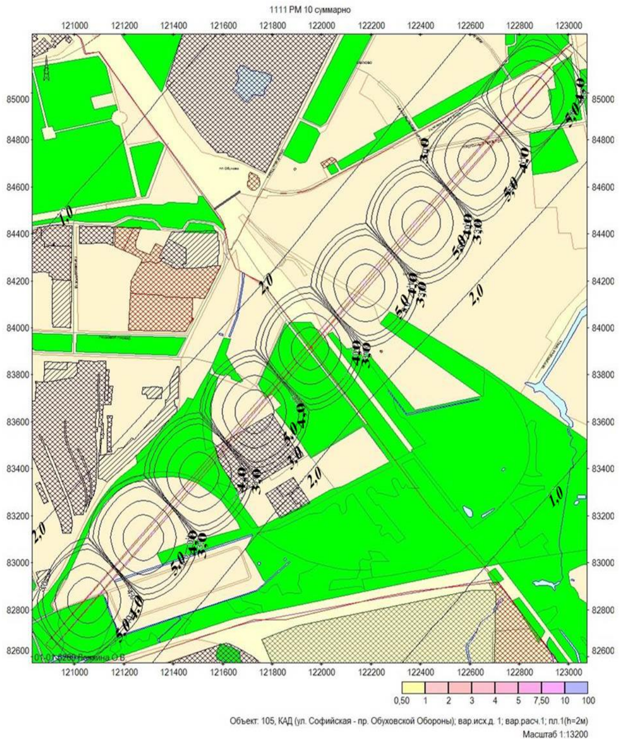
Рисунок 25 (а) – Визуализация загрязнения приземного воздушного бассейна частицами PM_{10} на участке от Софийской улицы до проспекта Обуховской Обороны на КАД СПб
