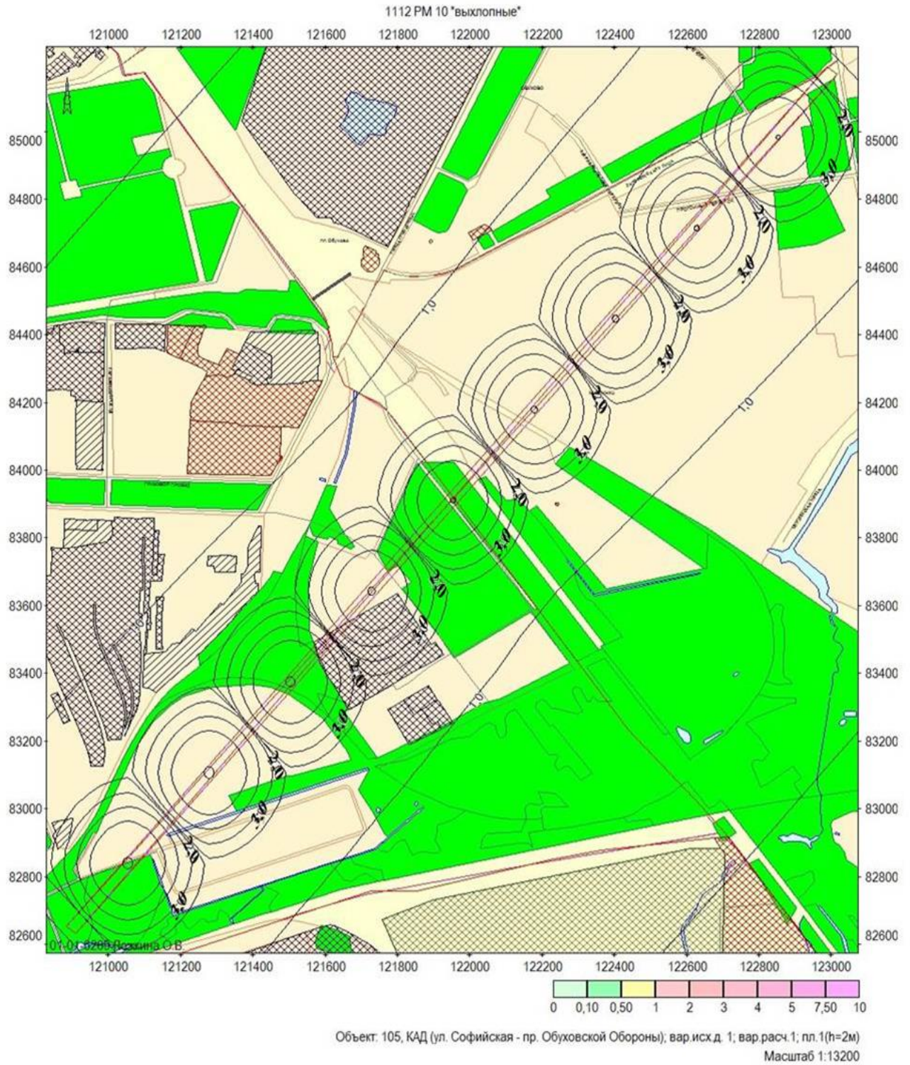
Рисунок 25 (б) – Визуализация загрязнения приземного воздушного бассейна «выхлопными» частицами PM 10 на участке от Софийской улицы до проспекта Обуховской Обороны на КАД СПб
