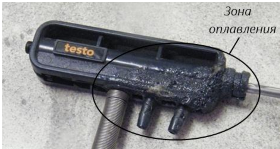
Рисунок 11 - Оплавленный пробоотборный зонд
